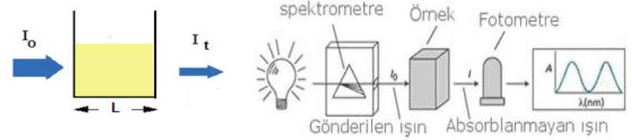
Spektrofotometre'nin çalışma prensibi
